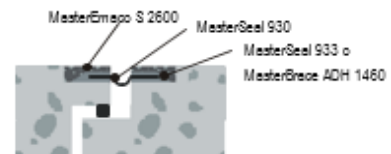
Sellado de juntas de dilatación específicas
