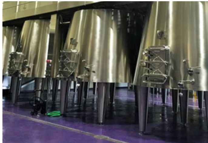
Sala Fermentación en depósitos acero inoxidable, revestimiento MasterTop 1324
